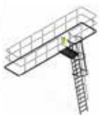
Лестница и перила для доступа к самой высокой части котла ( только модели STX 10-12, 15-20, 25-30 )
